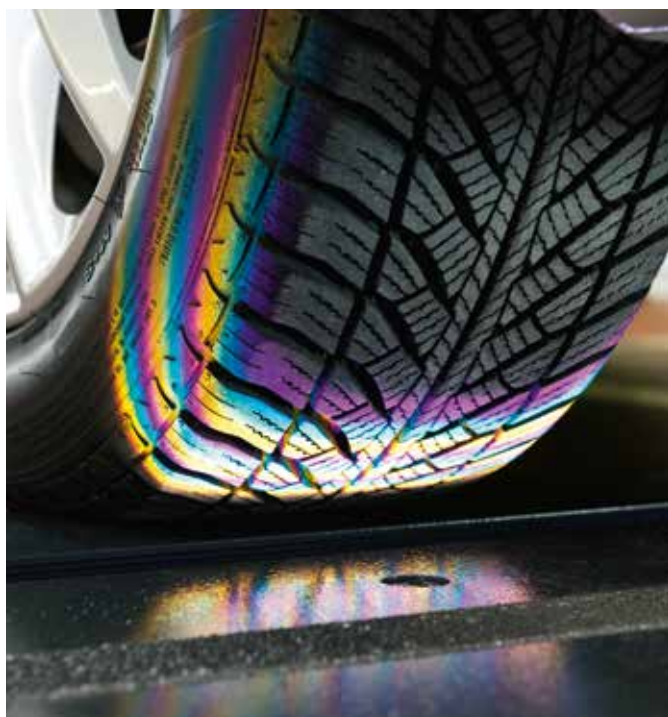
Měření hloubky dezénu pneumatik TTM (Tire Tread Measurement) se spustí automaticky, když vozidlo přejede přes měřicí lištu
