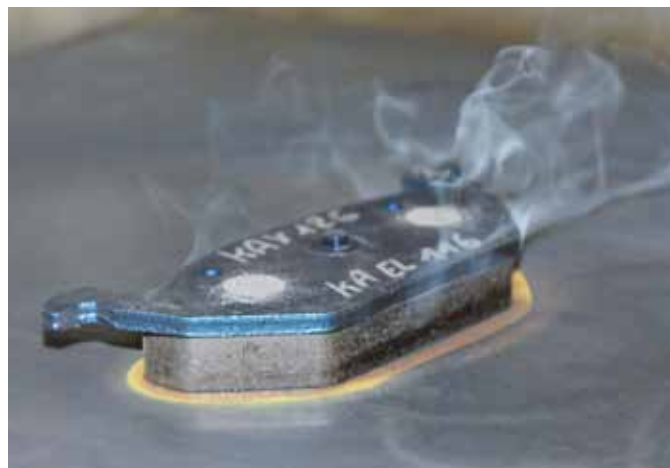
Vysokoteplotní zpracování brzdového obložení při vývoji v brzdové laboratoři
