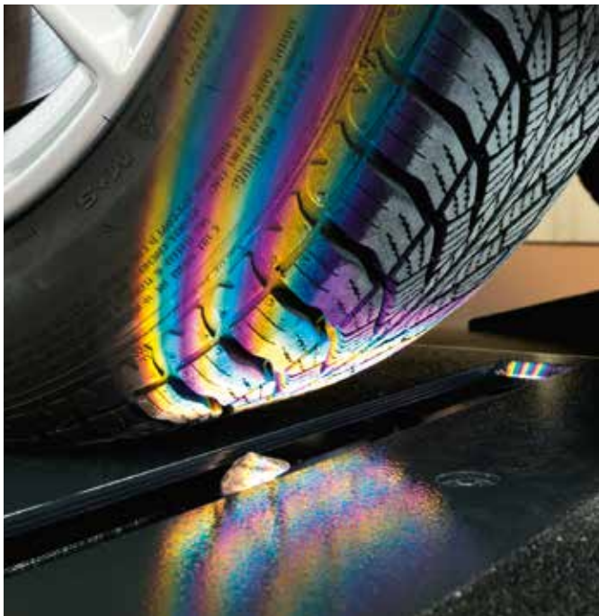
Malé objekty a nečistoty na projekční straně nemají vliv na výsledky měření
