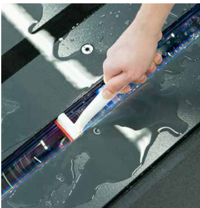
Mimořádně rychlé a snadné čištění měřicí lišty z vnějšku bez otevření mechaniky
