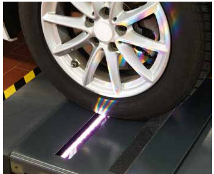
Měřicí technika je založena na barevném kódování – žádné pohyblivé díly, necitlivost vůči prachu, vibracím a vlhkosti
